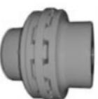
Flexível e torçionalmente elástico, com elementos em poluretano. Admite desalinhamentos radiais, axiais e angulares entre os eixos acoplados e absorve vibrações da máquina movida ou motora. Em 12 tamanhos, com capacidades de 10.000 a 580.000 Nm e eixos com diâmetros de 30 mm a 470 mm.
