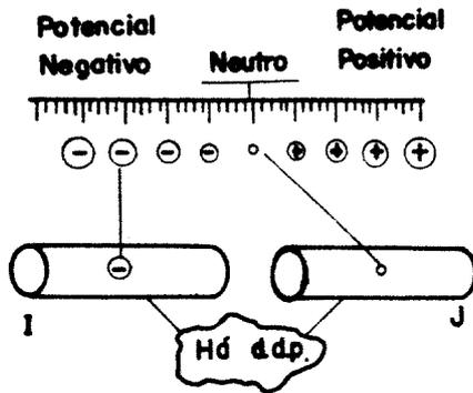
O material ( I ) está com carga elétrica negativa. O material ( J ), com carga neutra. Portanto, existe d.d.p. entre eles
