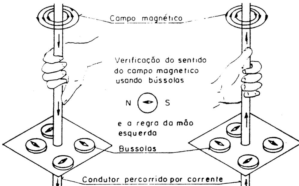
A experiência de Oersted demonstra que, estando o condutor acima da agulha com a corrente na direção N, a ponta da agulha desvia-se para a esquerda.
