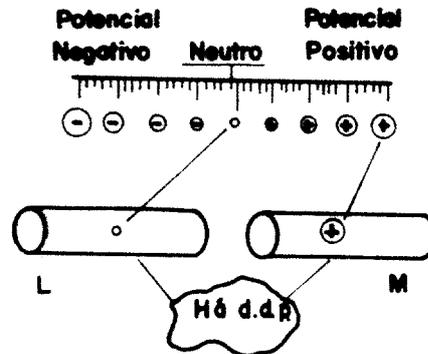
O material ( L ) está com carga elétrica neutra. O material ( M ), com carga elétrica positiva. Portanto, existe d.d.p. entre eles.
