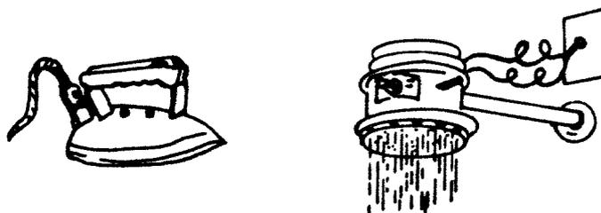
Começemos pela ligação do chuveiro: se o aparelho não tiver as características técnicas adequadas quanto à corrente, tensão e resistência, em função da rede elétrica de sua casa, poderão ocorrer alguns acidentes.
