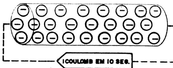
Então, para se poder realmente medir e comparar a corrente elétrica, houve a necessidade de se medir a intensidade da corrente em relação ao tempo.
