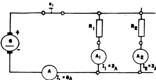
Se ligarmos outro consumidor,  $R_2$ , em paralelo com  $R_1$ , a corrente que circula por  $A$  será: a corrente que circula por  $R_1$  mais a que circula por  $R_2$ : Assim:
