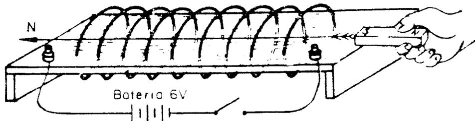
Colocando-se dentro da solenóide um núcleo de ferro batido, as linhas magnéticas, antes dispersas no ar, nele se concentram, resultando um campo magnético fortíssimo.
