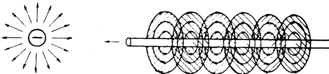
O elétron parado, contém linhas de força eletrostática no sentido radial.
