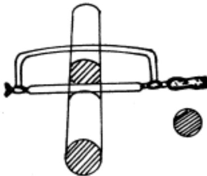
Seção Transversal é a área do material, quando este é cortado transversalmente.
