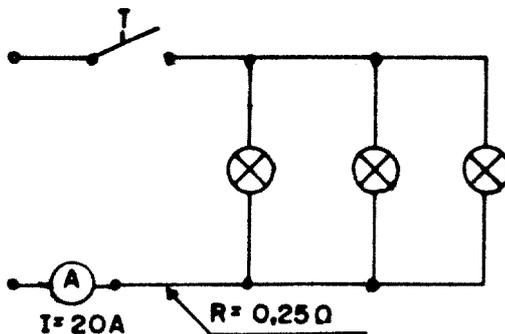
No circuito ao lado, a corrente é de 20 A e a resistência de um condutor é de 0,25  $\Omega$ .
