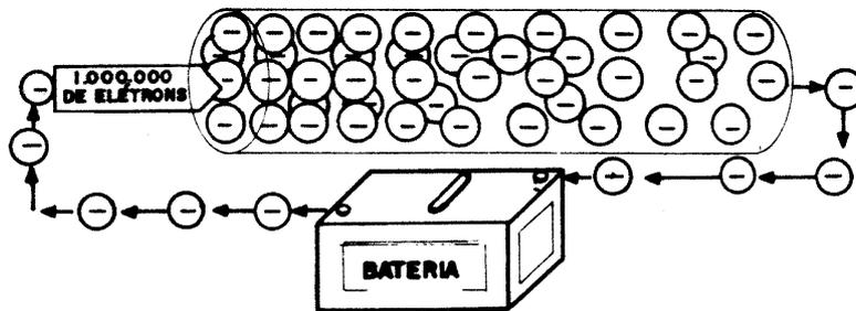
As fontes geradoras produzem, por um determinado espaço de tempo, uma f.e.m. constante. Portanto, será constante também o movimento de elétrons do extremo B para o extremo A do material, o que manterá o desequilíbrio elétrico do material.
