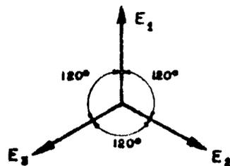
Quando ligamos a uma linha trifásica três fontes receptoras, ou três elementos de uma fonte receptora, temos um circuito trifásico.
