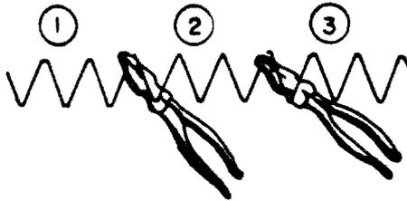
Com 1 resistor, a tensão era de 60 V. Dividindo o resistor em 3 partes, a tensão será de 20 V em cada parte.
