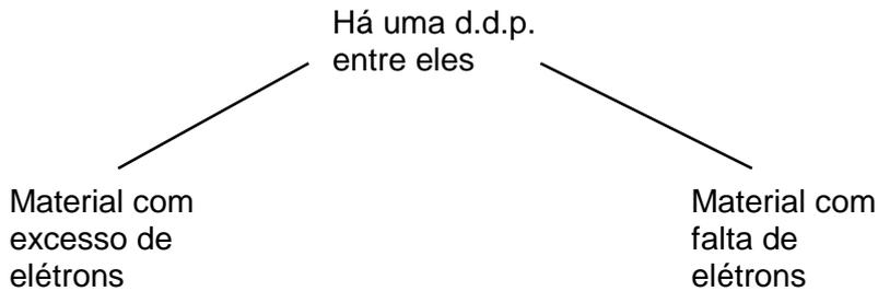
[ A d.d.p. será sempre a comparação entre duas cargas elétricas.]
