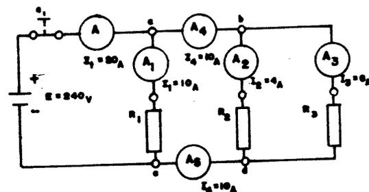
Agora... qual é a resistência dos resistores  $R_1$ ,  $R_2$  e  $R_3$  do circuito?
