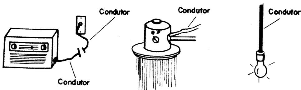
O condutor elétrico faz a ligação entre o consumidor e a fonte geradora, permitindo a circulação da corrente.
