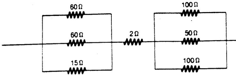
59) Este conjunto de resistores foi submetido à d.d.p.  $U = 2,4V$ .
