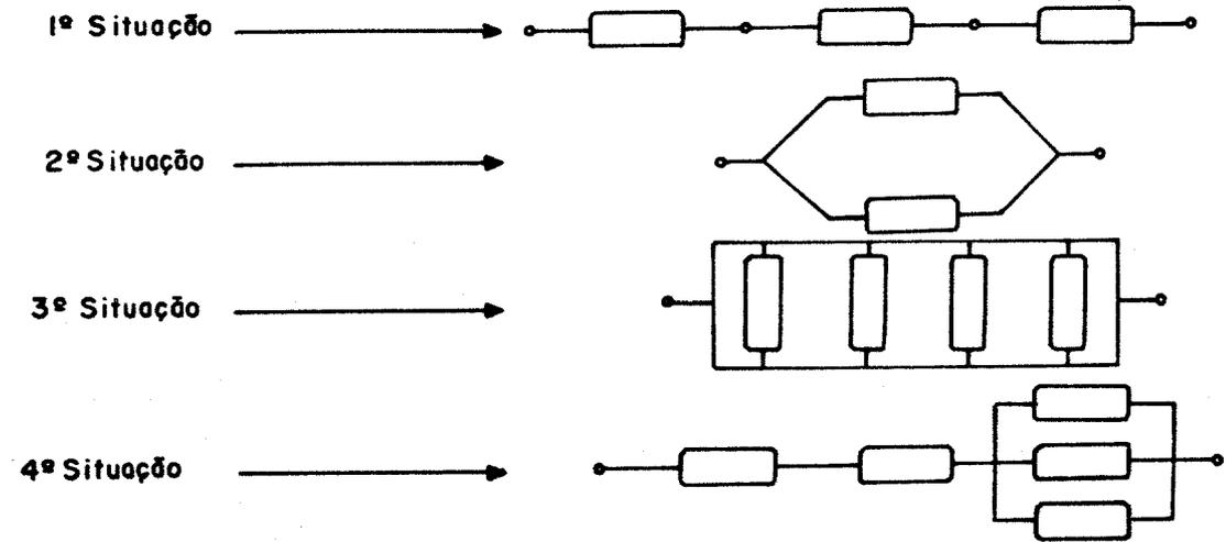
Esses meios de unir resistores são muito usados em eletricidade quando se pretende obter uma resistência elétrica adequada para um certo trabalho:
