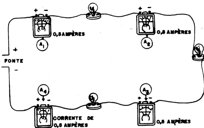
Em qualquer ponto do circuito em série, em que for ligado o amperímetro, o resultado da leitura será ampère, mesmo porque a corrente que circula pelos consumidores é também a mesma, em qualquer ponto do circuito.
