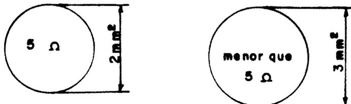
Na figura acima, vemos dois materiais de mesma natureza e de igual comprimento, porém, com seção transversal diferente:
