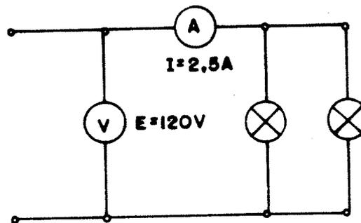
No circuito ao lado a corrente das lâmpadas é de 2,5 A quando aplicamos 120 V. Qual é a potência do circuito?
