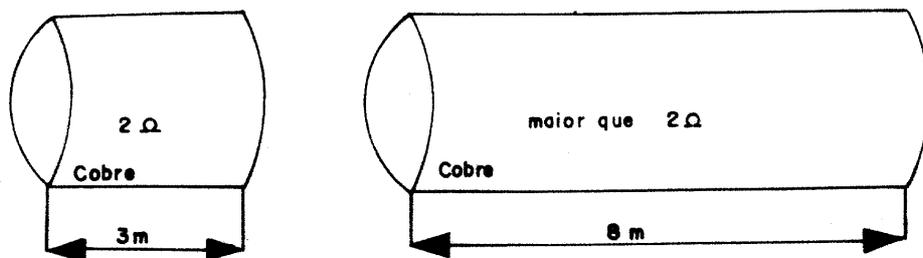
Na figura acima, temos dois materiais da mesma natureza; porém, com comprimento diferente:
