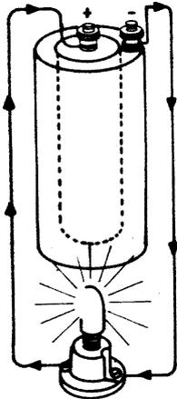
Assim para cada tensão aplicada num circuito teremos um resultado de corrente elétrica, isto tendo em vista um valor de resistência.
