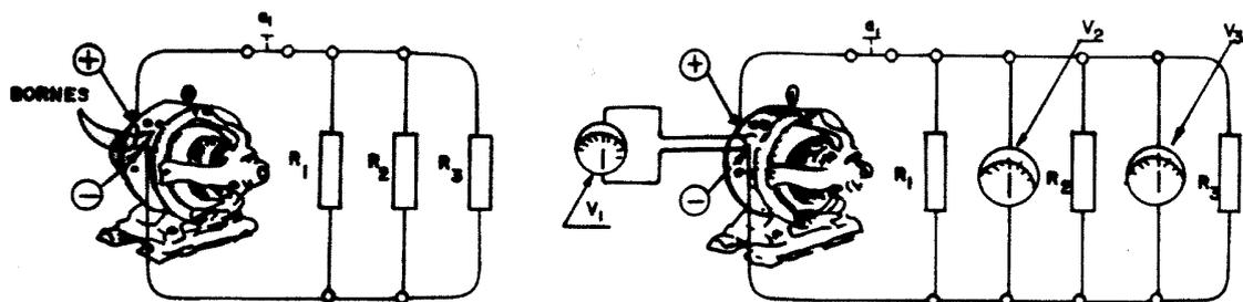
O que ocorre na 1ª figura, é o prolongamento dos bornes, através de condutores. Os voltmímetro  $V_2$  e  $V_3$  registram a mesma tensão de saída da fonte indicada pelo voltmímetro  $V_1$ , como você vê na 2ª figura.
