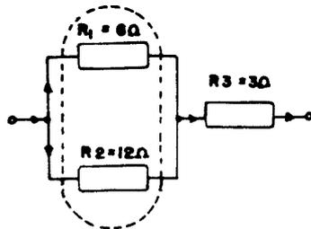
Determinado o ponto de partida para o cálculo da resistência total dessa associação, vamos calcular a resistência.
