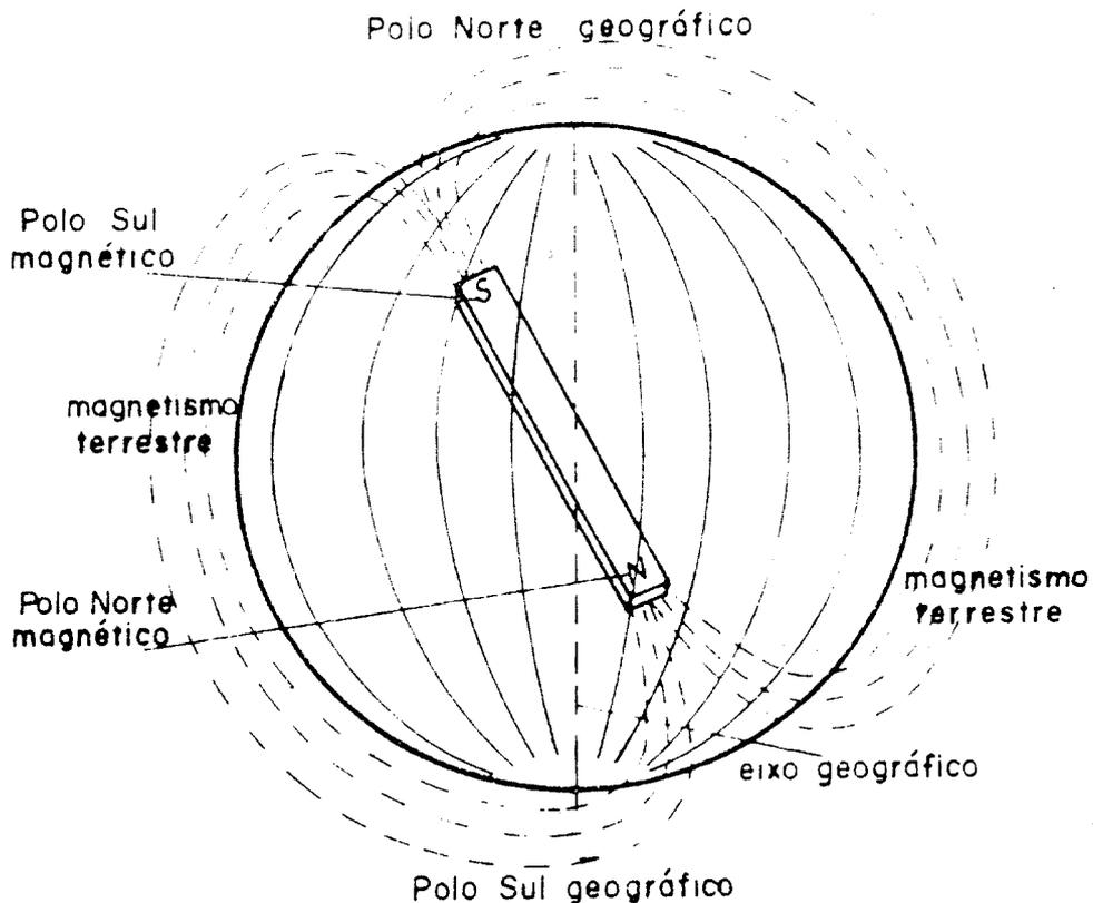
Outras causas do magnetismo terrestre são as correntes elétricas (correntes telúricas) originadas na superfície do globo em sua rotação do oriente para o ocidente e a posição do eixo de rotação da terra em relação ao sol.
