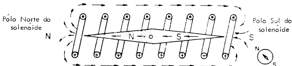
A ponta N da agulha aponta o pólo Sul do solenóide quando a mesma é colocada fora do solenóide. O mesmo não acontece quando a bússola é colocada dentro do solenóide; o N da agulha fica voltado para o pólo N do solenóide.
