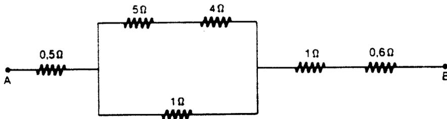
61) Calcule a resistência equivalente a cada conjunto de resistores:
