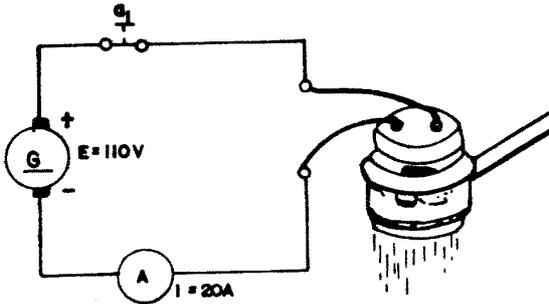
Qual seria a resistência do chuveiro, para ele poder funcionar dentro das condições ideais?
