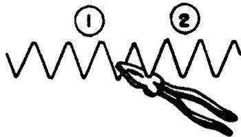
Se ligarmos as duas partes em série, como mostra o diagrama, a tensão será de 60 V na fonte geradora e de 30 V para cada parte.
