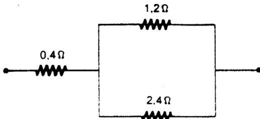
60) Aplicou-se d.d.p. de 90V entre os pontos A e B deste sistema. Calcule a corrente em cada resistor.
