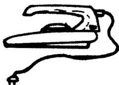
Ferro elétrico: Condutor elétrico flexível, com isolação de plástico e proteção térmica.
