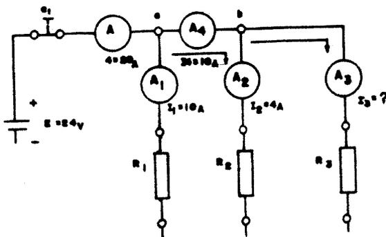
Após a divisão da corrente no ponto “ a “ parte dela continuou até “ b “. Ao chegar a “ b “, a corrente divide-se novamente. Então, se o valor de  $I_2$ , é 4 Ampêres, o valor de  $I_3$  será:
