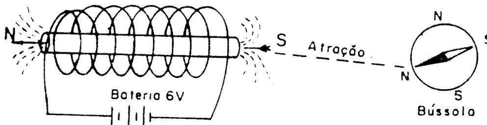
A densidade do campo magnético do solenóide, com núcleo de ar, obtém-se com a fórmula:
