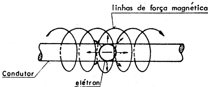
Quando o elétron percorre um condutor, ele cria um campo magnético concêntrico ao condutor, cujas linhas de força giram no sentido dos ponteiros do relógio, quando o sentido do movimento do elétron é da direita para a esquerda.
