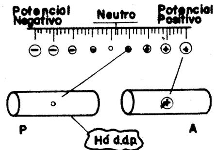
Entre os extremos (bornes) das fontes geradoras de energia elétrica existe Diferença de Potencial, sempre que a fonte geradora estiver funcionando:
