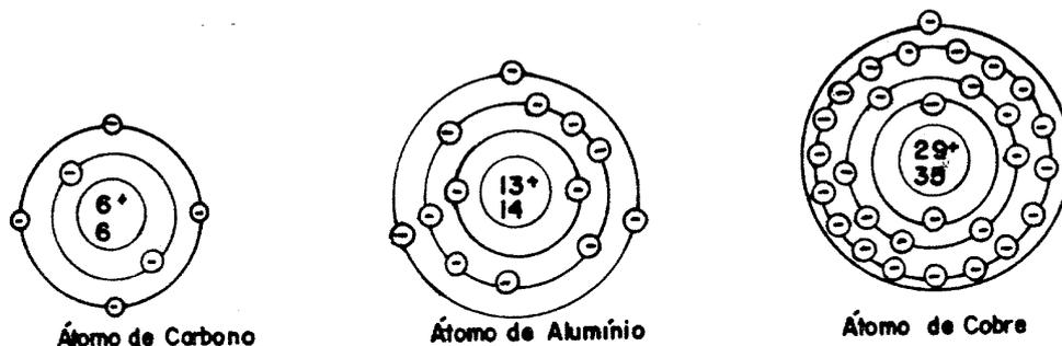
Note que, os átomos que constituem o carbono, alumínio e cobre são diferentes entre si. A diferença nos valores de resistência e condutância oferecidas pelos diferentes materiais, deve-se principalmente ao fato de que cada material tem um tipo de constituição atômica diferente.
