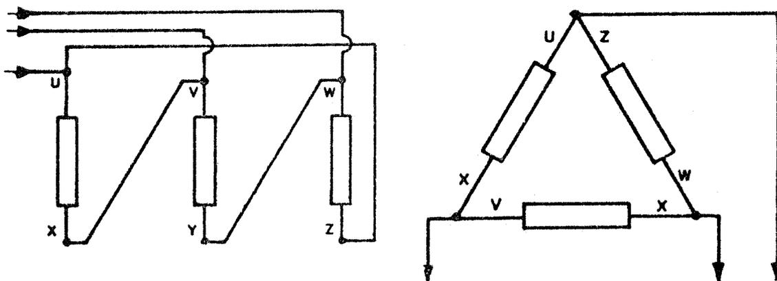
Os elementos de um receptor trifásico são representados respectivamente por U - X, V - Y e W - Z, onde U, V e W representam as extremidades iniciais, ou por 1-4, 2-5 e 3-6, sendo 1, 2 e 3 os inícios, pois cada elemento tem sua polaridade que deve ser conservada na ligação. A distribuição de energia elétrica é feita em geral em sistemas trifásicos, cujas redes podem ser ligadas em estrela ou triângulo.
