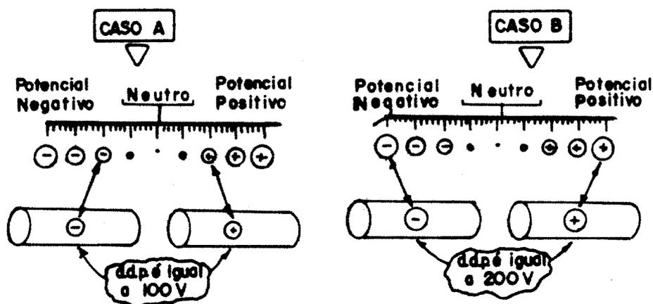
Em ambos existe d.d.p. No caso A, a d.d.p. corresponde a 100 volts. No caso B ela é bem maior; corresponde a 200 volts.
