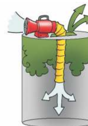
VENTILAÇÃO PRESSÃO POSITIVA
