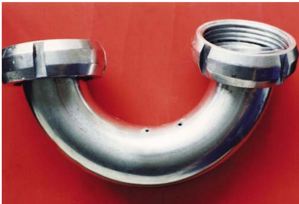
FIGURA 9 – CORROSÃO POR PITE EM AÇO INOXIDÁVEL
