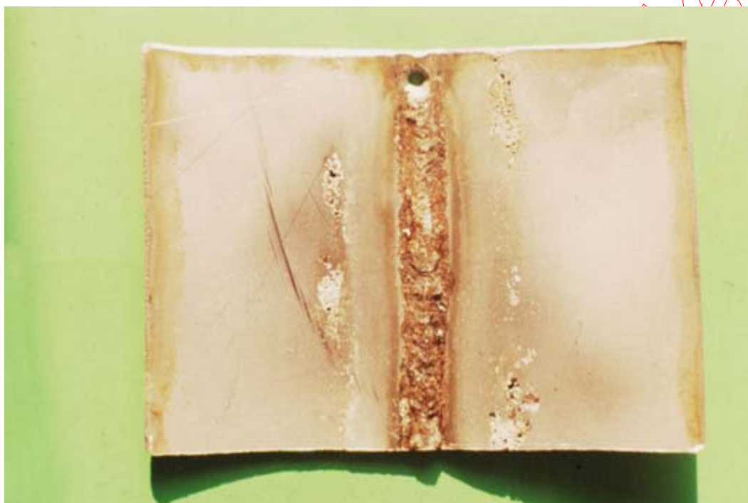
FIGURA 10 – CORROSÃO EM TORNO DE CORDÃO DE SOLDA EM AÇO INOXIDÁVEL
