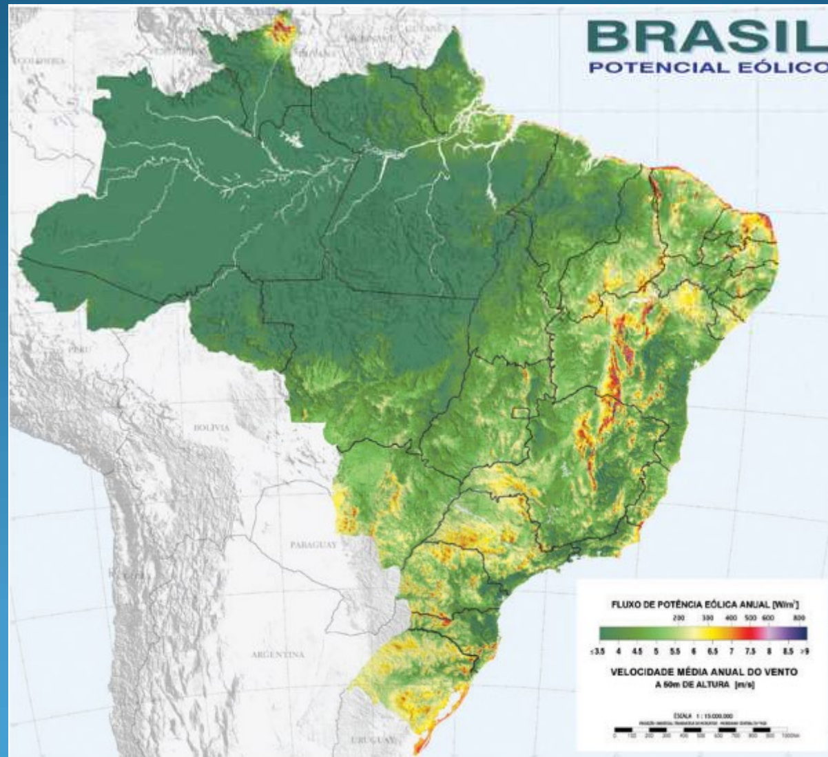
Figura 7 – Potencial Eólico Brasil – Velocidade Média do Vento à 50 mts de Altura em m/s
