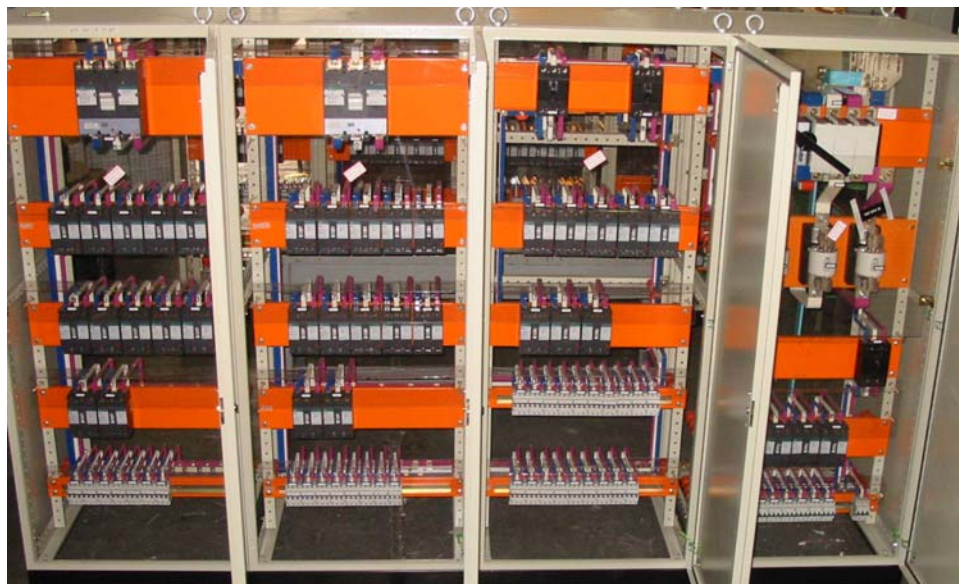
Figura 3 - Conjunto do tipo multi-colunas – Montagem “QGBT” – Cliente: Oas – Mercado SP.
