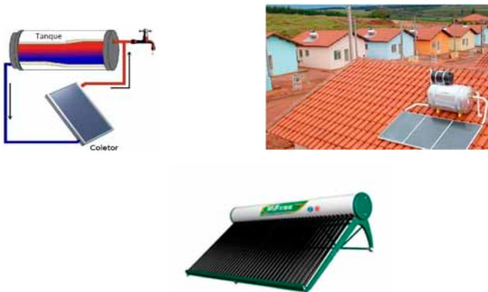
Fig. 5.5 – Esquerda: o aquecimento solar baseia-se na convecção natural da água. Direita: emprego de coletores planos num conjunto habitacional no Brasil. Abaixo, sistema mais popular na China com o coletor plano sendo substituído por tubos de vidro evacuados, mais adequados a climas temperados.
