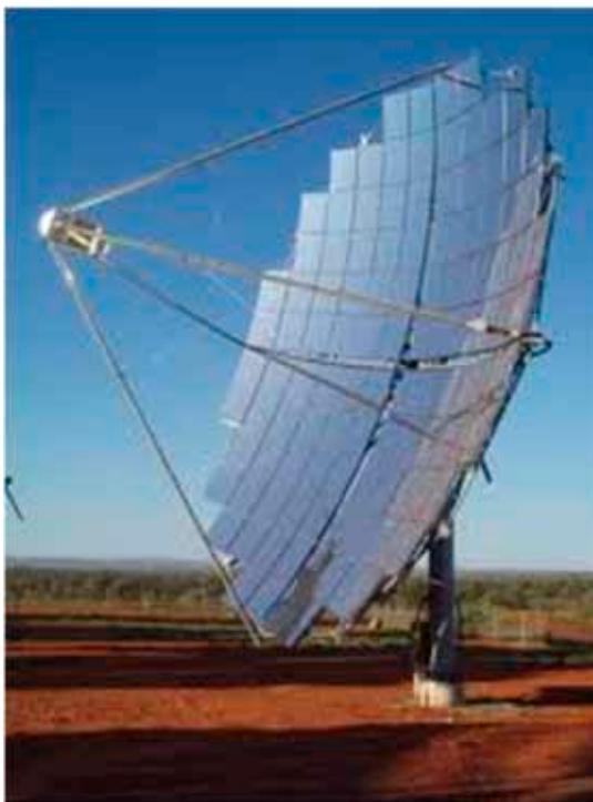
Fig. 7.6 Sistema concentrado fotovoltaico (CPV) utilizando espelhos parabólicos.
