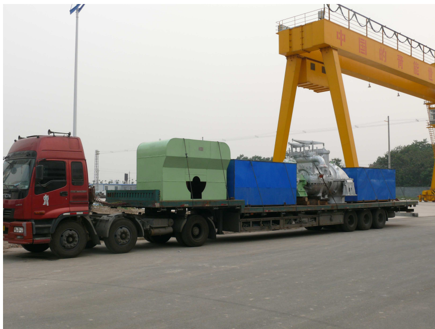
Transporte de uma turbina Condensante de 20MW.
