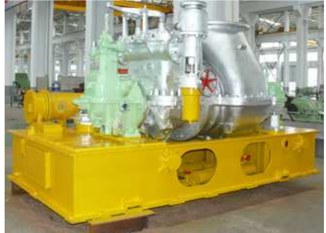
Montagem da turbina em Skid único
