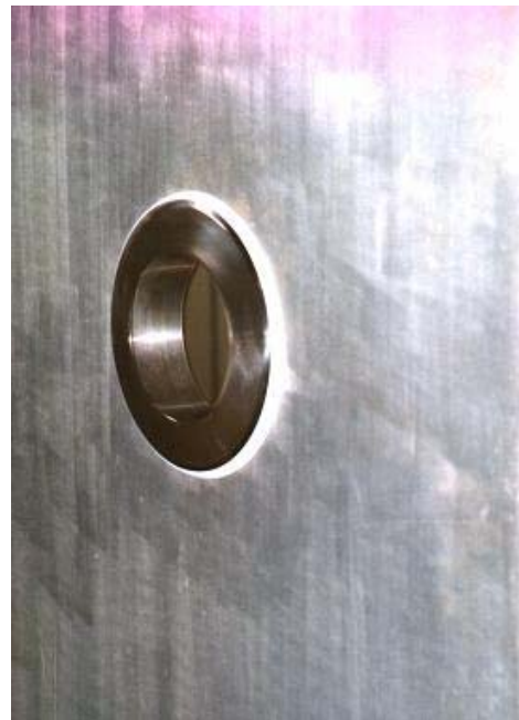
Adaptador visto do lado interno do tanque
