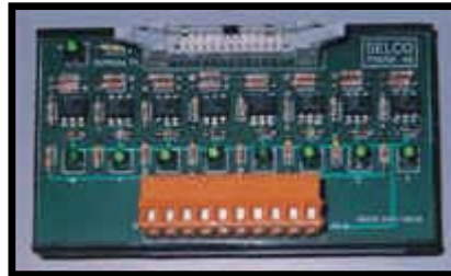
Placa com acopladores ópticos.
