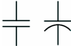
Figura 5 – Simbologia para representação da capacitância em desenhos elétricos.
